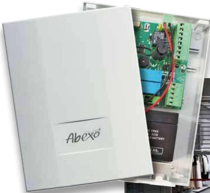
Le **SH230POWER** est une unité de contrôle électronique avec récepteur intégré compatible avec tous les codes fixes 433 Mhz et certains codes déroulants 433 Mhz\*. Sa particularité réside dans sa capacité à piloter et de débloquer le frein électrique des moteurs même en cas de coupure d'alimentation 230V, grâce à une batterie tampon. La fonction est activée en appuyant simultanément sur 2 boutons pendant plus de 3 secondes.
