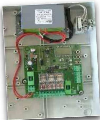
L'unité **TRAFFIC CONTROL** permet de gérer des systèmes de feux de circulation bidirectionnels, c'est-à-dire avec jusqu'à deux feux de circulation avec 2 ou 3 feux (230V ou 24V)
